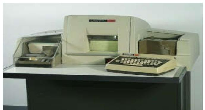
**Figura No. 3. Perforadora y verficadora Univac 1701 y 1710**
