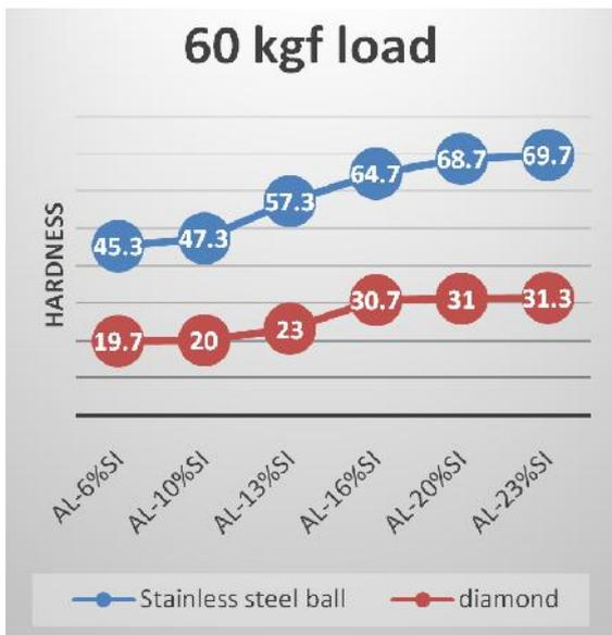
Fig. 15. Hardness values for 60 kgf load
