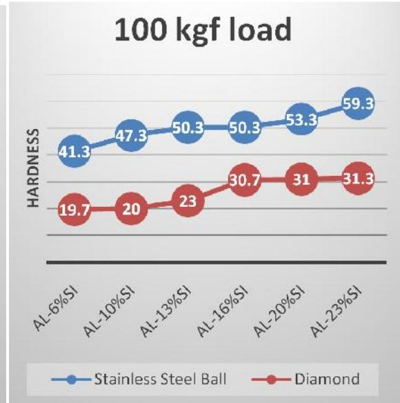
Fig. 16. Hardness Values for 100 kgf load
