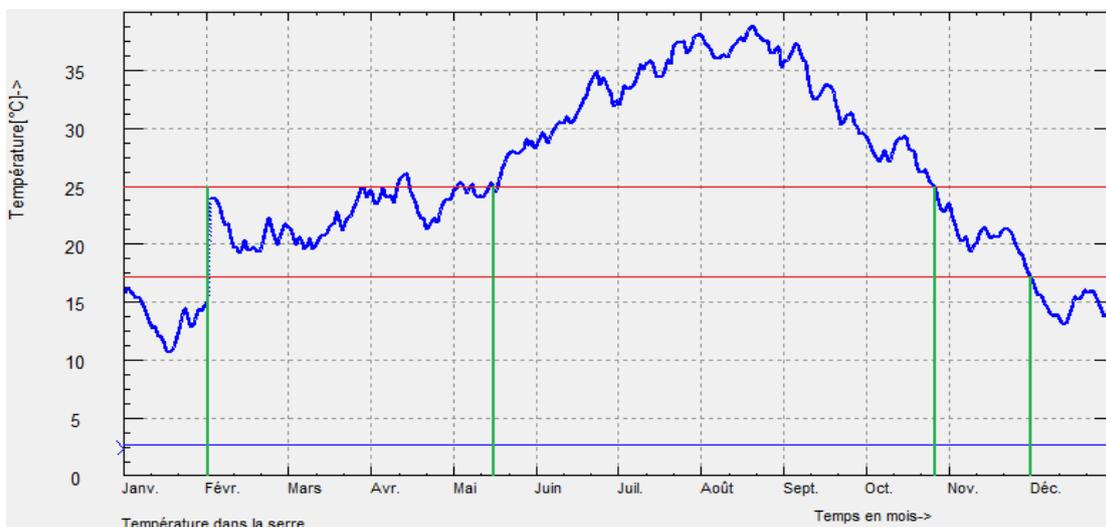
Fig.6. Evolution de la température de l'air intérieur
