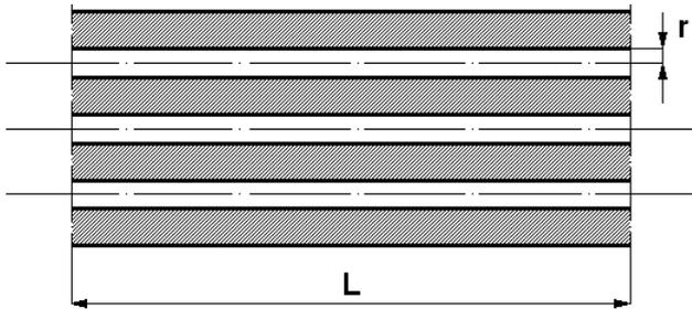
Fig. 3. Structural model of the porous capillary body (Aksielrud & Altszuler, 1987): L - długość, r - promień
