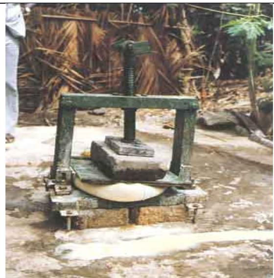
Figure 12 : Essorage au moyen d'une presse à vis
