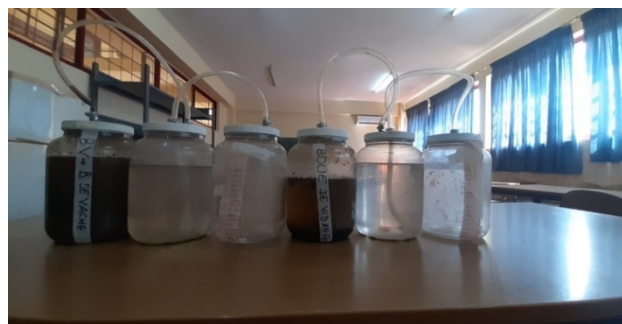
Figure n°2. Dispositif de production du biogaz au laboratoire de Physique-Chimie-Technologie de l'ISSEG de Lambanyi-2025
